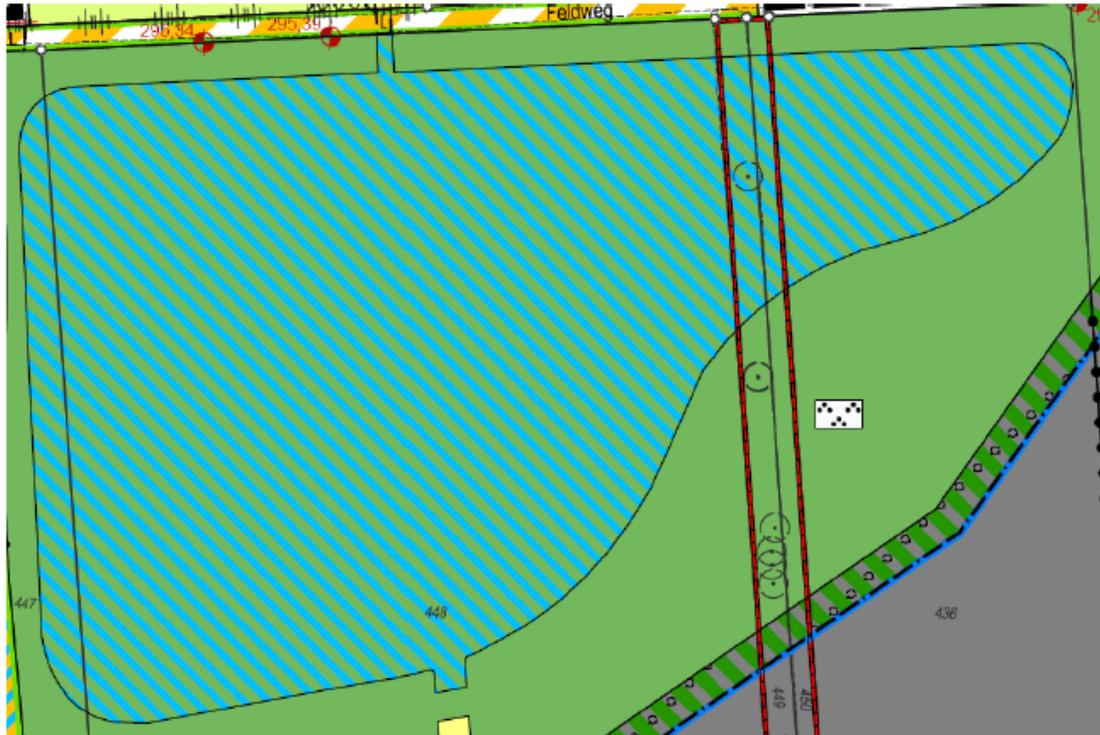
Rückhaltebecken mit dem flächigen Einstau und dem entsprechenden Volumen, geometrisch genau !
