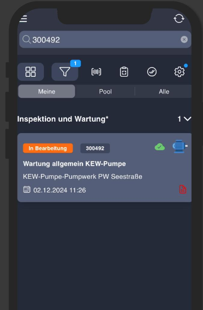
Vor Ort scannt die Fachkraft den QR-Code / RFID-Tag und bekommt den zugeordneten Auftrag und das Instandhaltungsobjekt angezeigt
